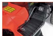
Hydrostatická automatická převodovka jednoduše ovladatelná pomocí pedálu
