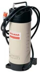
Nezávislý přívod vody pro rozbrušovací pilu. Tlaku dosáhneme pomocí ruční pumpy až na 3-5 baru a ten tlací proud vody až k brusnému kotouči. Je vhodný pro zásahy v různých pracovních výškách. Praktické: chladící tryskou může být rozbrušovací pila po práci vycištěna.
