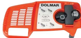
**TLC:** Pro napnutí řetězu stačí pouze uvolnit matici s křídlovými držáky a napnutí řetězu upravit pomocí seřiditelného kola
