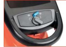
Bezpečnostní vypínač s ochranou proti přetížení.
