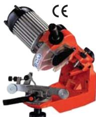
Osvědčená bruska s motorem 230 V, 2800 ot./min, brusné kotouče 145 mm, pro profesionální, přesné a rovnoměrné broušení pilových řetězů DOLMAR s vestavěným osvětlením pracovní plochy.
