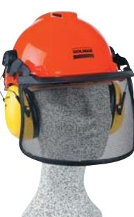
Ochranná přilba G22d, atest KWF = FPA, kovový štít V4c se sluneční clonou, hustota ok 1,8 x 2,5 mm, nerezová ocelová síťka s propustností světla 75 %, s ochranou sluchu H510P3e, SNR 26 dB(A).
