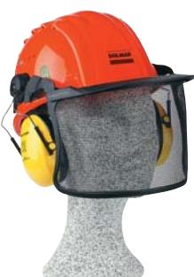
Ochranná přilba Profi Plus, atest KWF = FPA, kovový štít V4c se sluneční clonou, hustota ok 1,8 x 2,5 mm, nerezová ocelová síťka s propustností světla 75 %, s ochranou sluchu H510P3e, SNR 26 dB(A).
