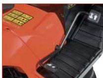
Hydrostatická automatická převodovka jednoduše ovladatelná pomocí pedálu.
