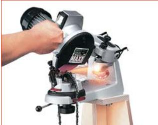
Bruska řetězů **MAXX** nabízí praktické a účinné řešení pro profesionální broušení pilových řetězů. Zejména automatické upnutí pilového řetězu ve vodicí liště při zmačknutí brousicí hlavy racionalizuje broušení řetězů. **Sériově s osvětlením a 3 brusnými kotouči pro všechny běžné pilové řetězy se třemi lamelami a roztečem.**
