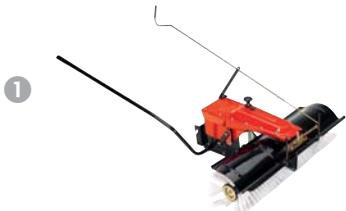
Zametací kartáč 110 cm pro zimní údržbu a čištění cest. Montáž na přídavný rám, 5násobně otočný.
