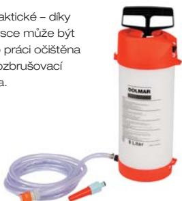
Stále více zákazníků požaduje účinná opatření při řezání v prašném prostředí. Proto je důležitá 8litrová tlaková nádrž z kvalitního plastu. Zaručuje nám spolehlivou dodávku vody, při řezání kamene nebo betonu. Tlaková nádrž je napojena na tlakové a samospádové vedení na rozbrušovací pile pomocí rychlospojky.
