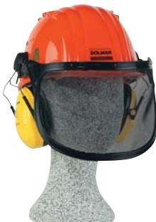
Ochranná přilba Profi Plus, atest KWF = FPA, plastový štít V1b bez sluneční clony, s polyamidovou síťí 0,3 mm, hustota ok 1,0 x 1,0 mm, s ochranou sluchu H510P3e, SNR 26 dB(A).
