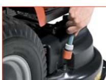
Připojka na vodu pro rychlé čištění žacího ústrojí.
